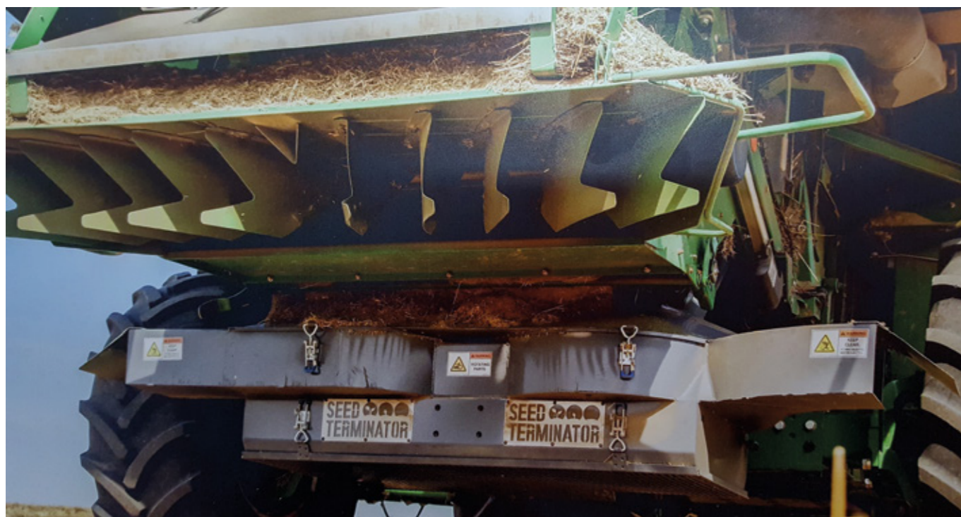
Der Seed Terminator aus Australien zerstört alle Körner in der Spreu, so dass keine Getreide- und Beikrautsamen mehr aufaufen können. Quelle Martin Trieschmann
